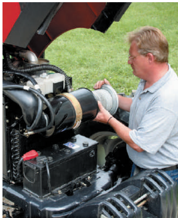
O filtro pode ser removido sem necessidade de ferramentas, tornando a manutenção mais rápida.
